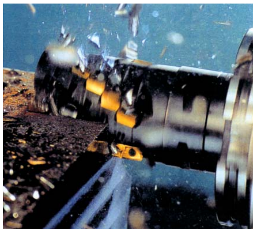
1 Fresa adatta a operazioni di contornatura.
