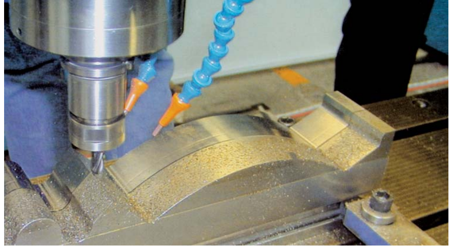
1 Fresatrice con ugelli per la fuoriuscita di acqua per raffreddamento. La macchina è impegnata nella lavorazione di un pezzo a superficie sagomata.
