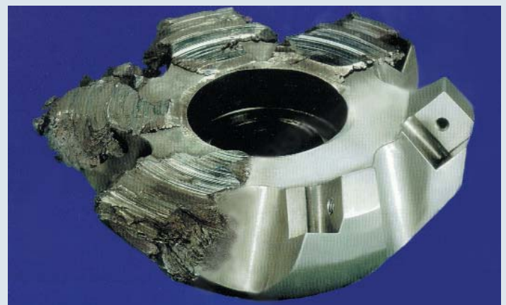
4 Esempio di utensile usurato.
