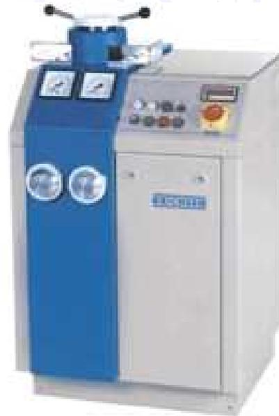
modello di dispositivo utilizzato per prove di imbutitura Erichsen
